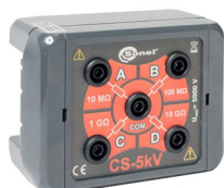
Scatola di calibra- zione CS-5 kV
